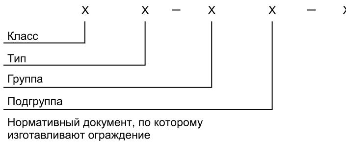
4.3 Подкласс удерживающего бокового ограждения для автомобилей обозначают цифрой 1\*. Типы ограждений обозначают цифрами:
